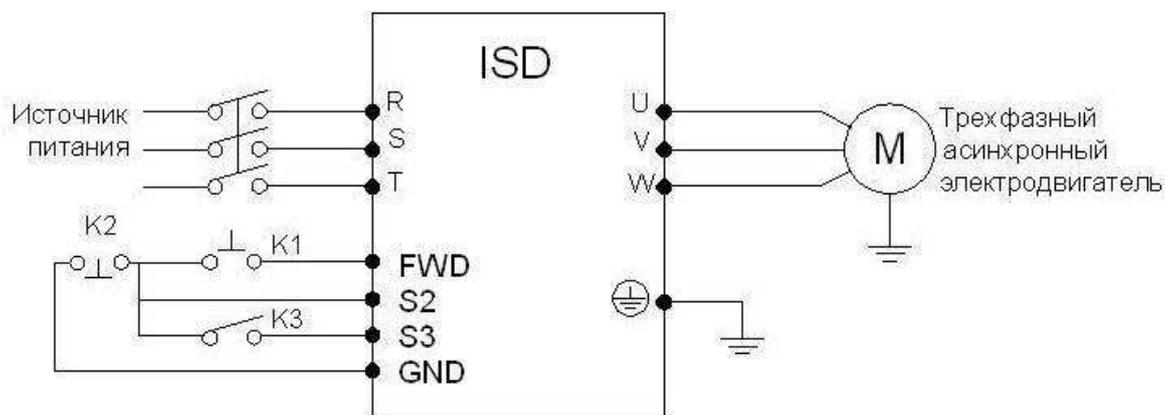
(2) Настройка параметра PF33 определяющего направления вращения
