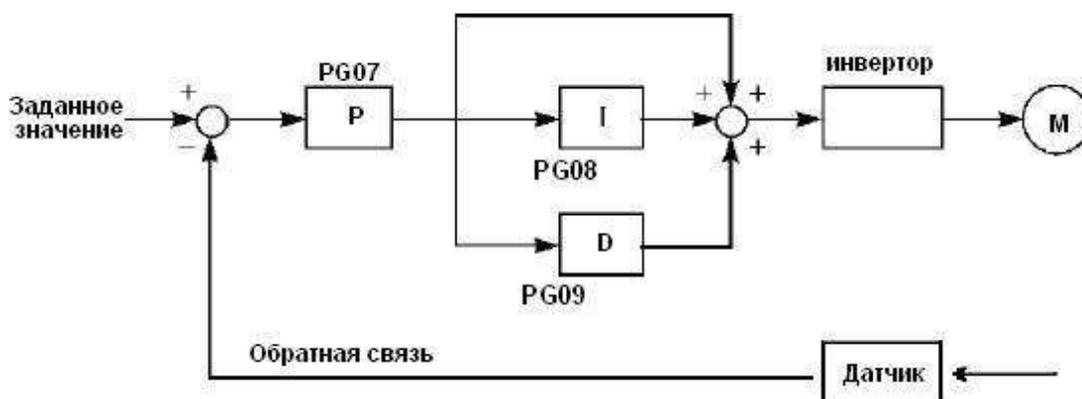
Замечания по использованию преобразователя в режиме PID-регулирования:
