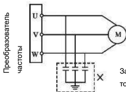
Запрещается подсоединять сглаживающие конденсаторы или иной блок с емкостным сопротивлением к выходным клеммам
