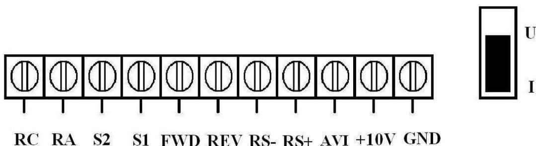
Момент затяжки винтов на клеммах - 0.2 Нм.
