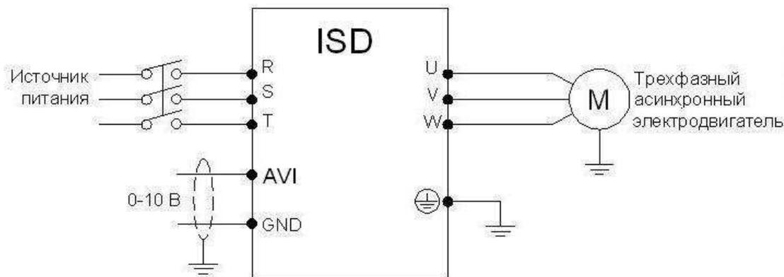
Аналоговое напряжение 0-10В можно сформировать внешним потенциометром 10кОм. Изменение частоты происходит при изменении напряжения от 0 до 10 В между клеммами AVI
