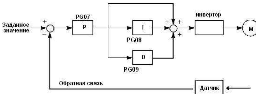
Замечания по использованию преобразователя в режиме PID-регулирования:
