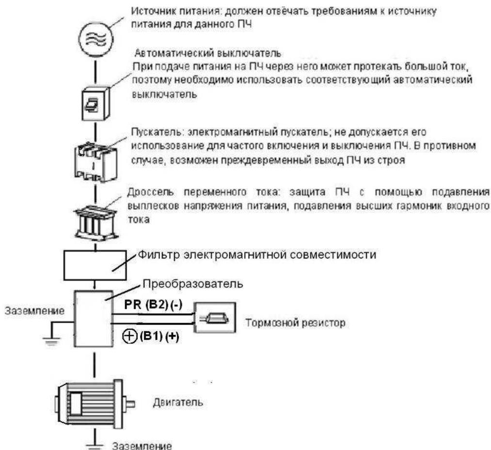
**⚠ Подключение проводов питания преобразователя следует производить только к клеммам L1, L2, L3.**
