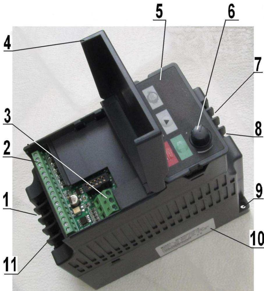
1. Клеммы для подключения электродвигателя U, V и W
