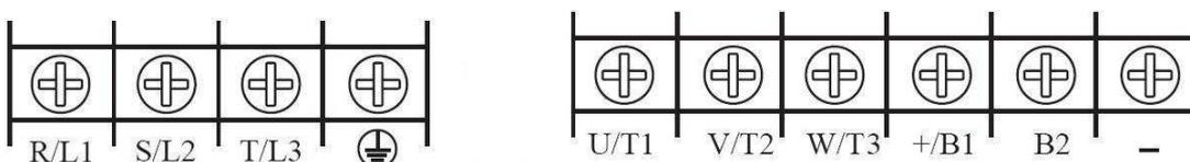
Тип корпуса 3. Трехфазные, 380 В, мощностью от 7,5 кВт до 11 кВт:
