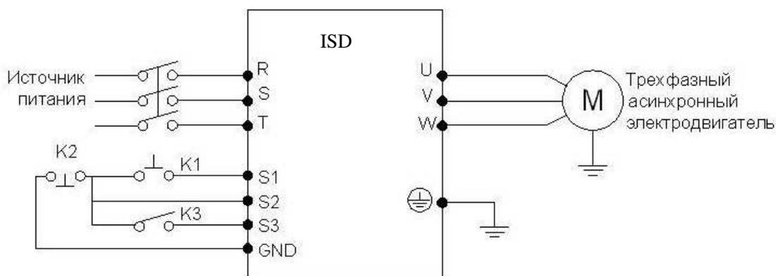
(2) Настройка параметра PF33 определяющего направления вращения
