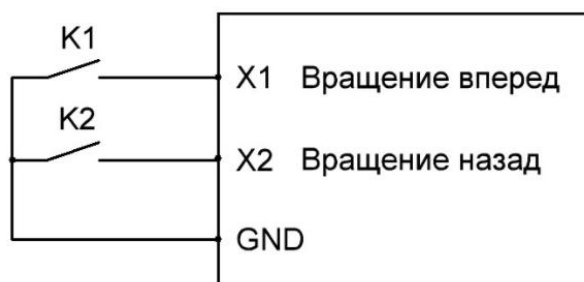
Рис. 5-11 Принципиальная схема двухпроводного режима работы
