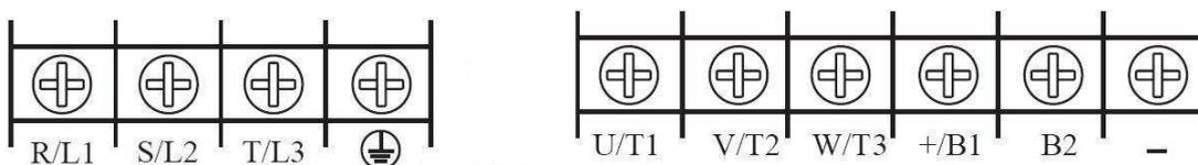
Момент затяжки винтов на силовых клеммах преобразователя 1.4 Нм.
