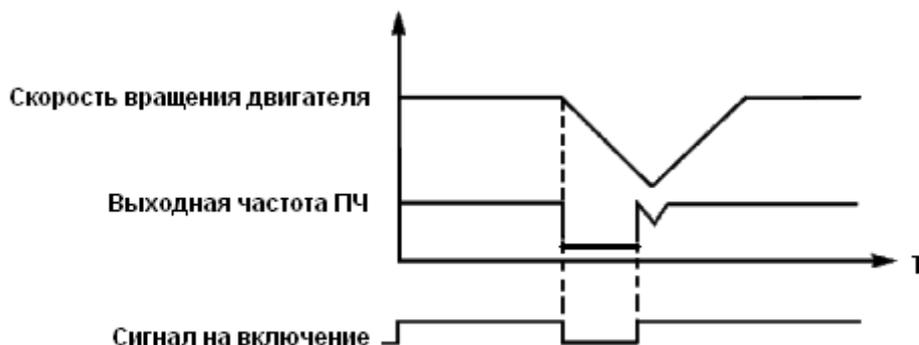
Внимание: во время запуска с поиском частоты ПЧ начинает поиск частоты с верхней границы до нижней границы частоты. Это может привести к возникновению перегрузки по току, поэтому необходимо правильно выбрать уровень перегрузки по току (параметр PE09) в зависимости от нагрузки.
