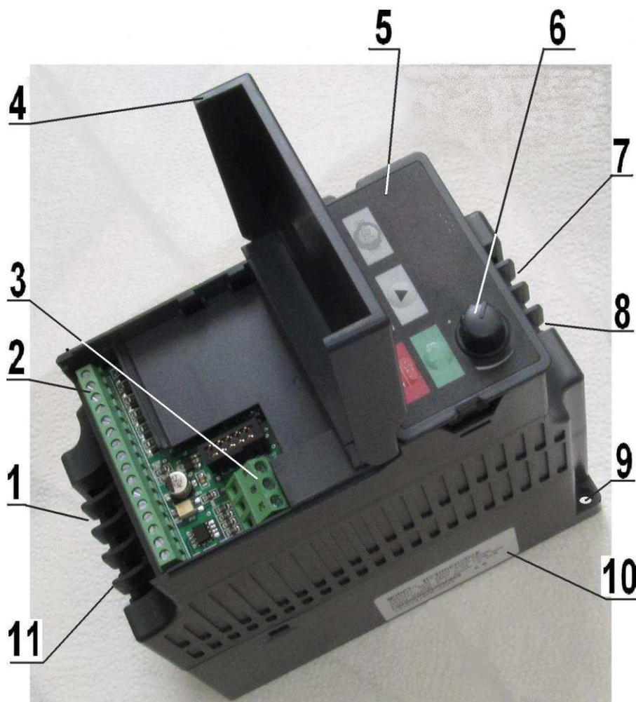
1. Клеммы для подключения электродвигателя U, V(W)\*
