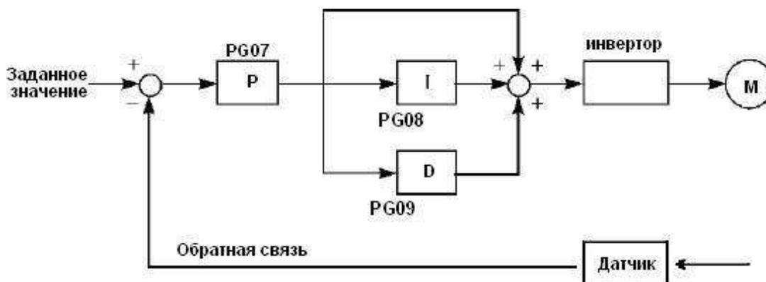
Замечания по использованию преобразователя в режиме PID-регулирования:
