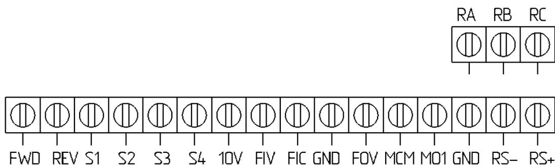
Момент затяжки винтов на клеммах RA, RB, RC – 0.4 Нм.
