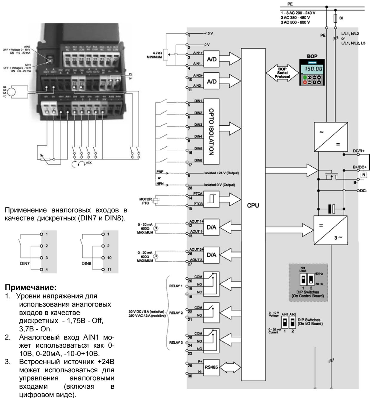
Рисунок 3-1 Блок-схема преобразователя частоты
