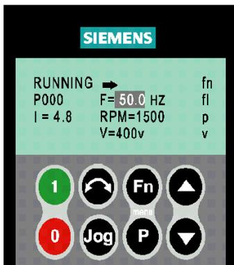
Расширенная панель оператора (AOP) доступна как опция. Она включает в себя следующие расширенные возможности.
