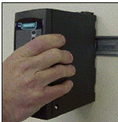
2. Прижмите нижнюю часть инвертора к рейке и нажмите до появления щелчка фиксатора.
