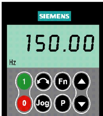
Базовая панель оператора (BOP), поставляемая как опция, дает возможность доступа к параметрам преобразователя и обеспечивает специфическую пользовательскую настройку MICROMASTER 440. BOP может использоваться для конфигурирования большинства преобразователей MICROMASTER 440. Поэтому нет необходимости покупать свою панель BOP для каждого преобразователя.
