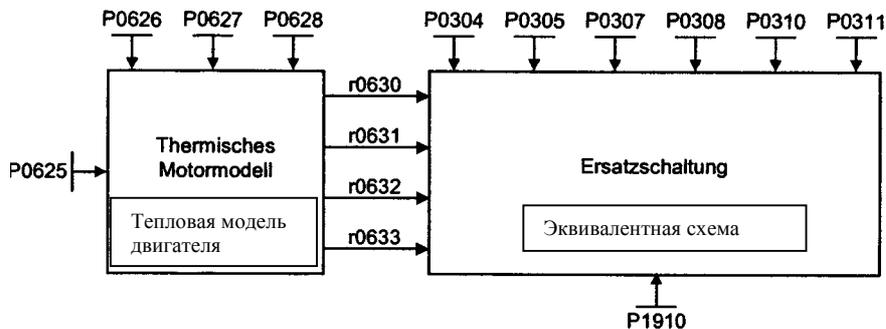
Параметр P0625 разрешается изменять только при условии, что температура двигателя равна температуре окружающей среды. Идентификацию данных двигателя необходимо производить после изменения P0625.
