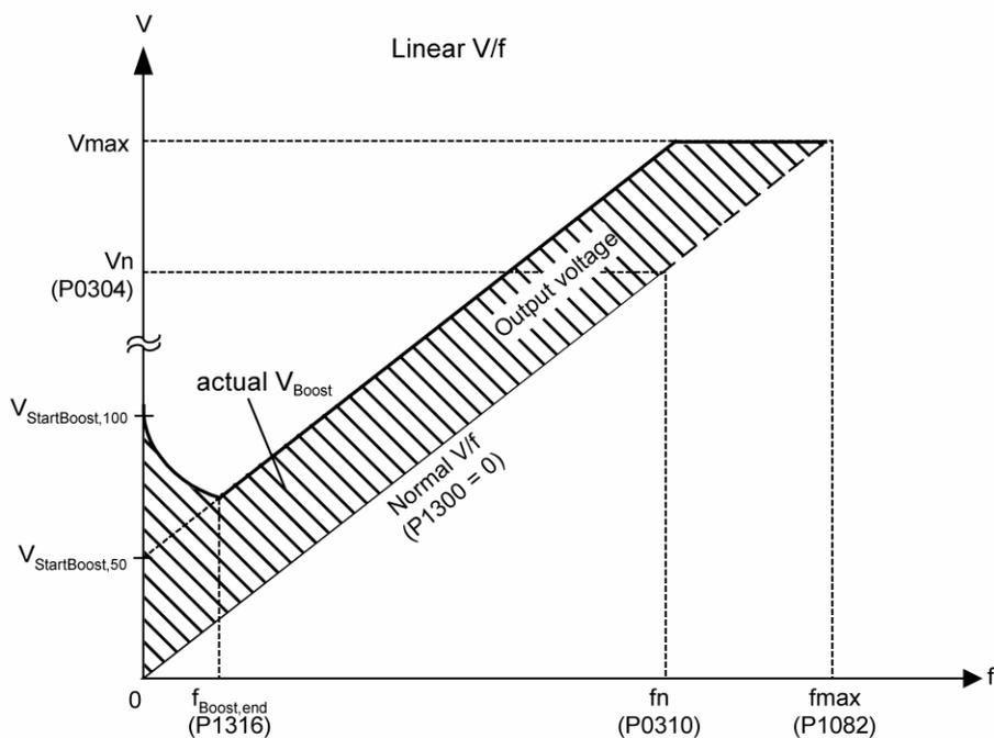
$V_{StartBoost, 100}$  = номинальный ток двигателя (P0305) \* сопротивление статора (P0350) \* добавочное напряжение при запуске (P1312).
