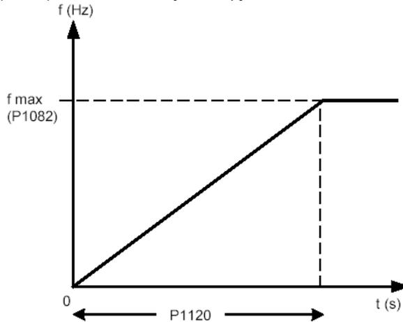
Установка слишком короткого времени разгона по рампе может привести к отключению вентильного преобразователя частоты (ток перегрузки).
